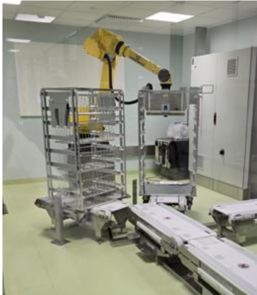
Chariot d'intervention conventionnel (ouvert) avec chargement et déchargement automatisés
