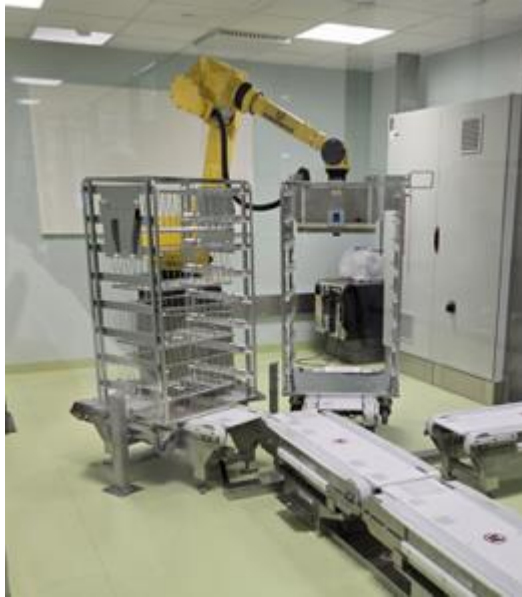
Konventioneller Fallwagen (offen) mit Roboter Be- und Entladung
