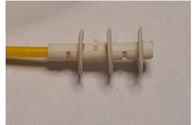
Parti sortant avec un diamètre qui frotte les parois interne du canal
