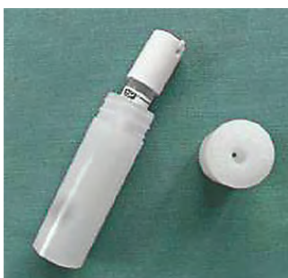
Abb. 49: Bioindikator im Prüfkörper (kleine Plastikflasche mit kleinem Loch)
