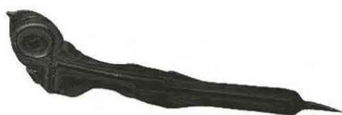
Abb. 105: Schritt 3 Aussengrat des Rohlings schneiden, Ring lochen, glühen
