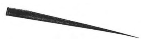
Abb. 104: Schritt 2 Rohling schmieden
