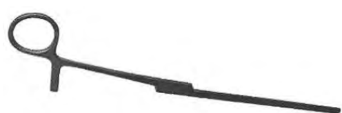
Abb. 105: Schritt 3 Aussengrat des Rohlings schneiden, Ring lochen, glühen
