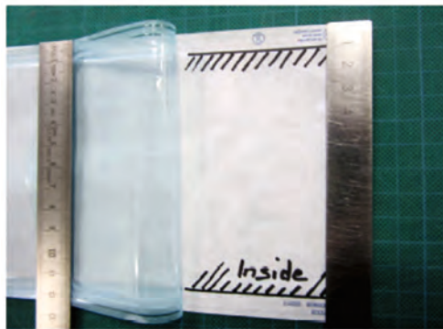
Abb. 15: Sauber erscheinender Peel ohne Abfaserung des Papiers in Richtung Innenseite
