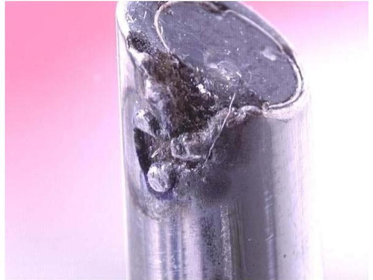
Trübes Bild, Nebel, Kratzer, undicht nach autoklavieren
