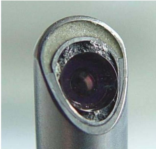
Dunkles Bild, undicht, trüb, Feuchtigkeit in dem Endoskop
