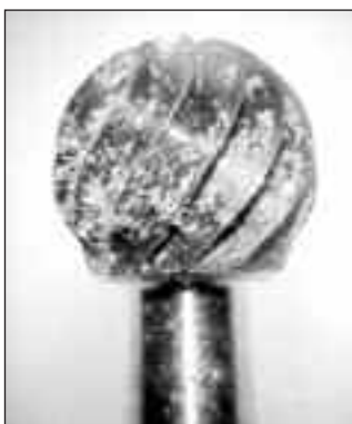
Abb. 6 Bohrfräse mit einem Durchmesser von 3 mm, schlecht gereinigt.
