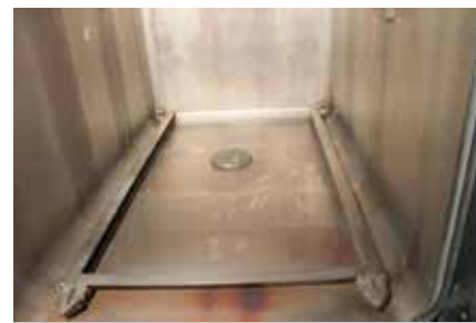
Avant derouging et passivation
